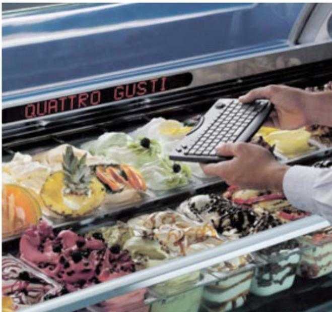
La barra LED permite visualizar un texto deslizable en tres colores en la cadena de 16 caracteres de paso. Le acompaña un teclado, que permite cambiar o modificar la frase a visualizar.
