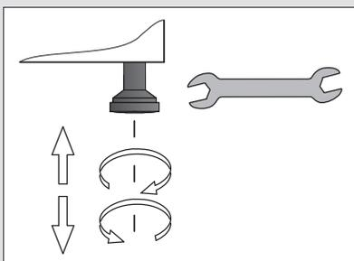
E' **assolutamente necessario** dopo il posizionamento livellare l' apparecchiatura.
