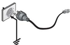
Al empezar y después de cada período de inactividad durante más de 8 horas sin energía (con el plug - Pulsar de "8" en OFF) es **necesario esperar 1 hora y 30 minutos** con el escaparate alimentado (conectado) antes de arrancar el compresor.
