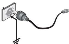
Al primo avvio e dopo ogni periodo di inattività superiore alle 8 ore senza alimentazione (con la spina disinserita - tasto "8" in OFF) è necessario **attendere 1 ora e 30 minuti** con la vetrina alimentata (spina inserita) prima di avviare il compressore.
